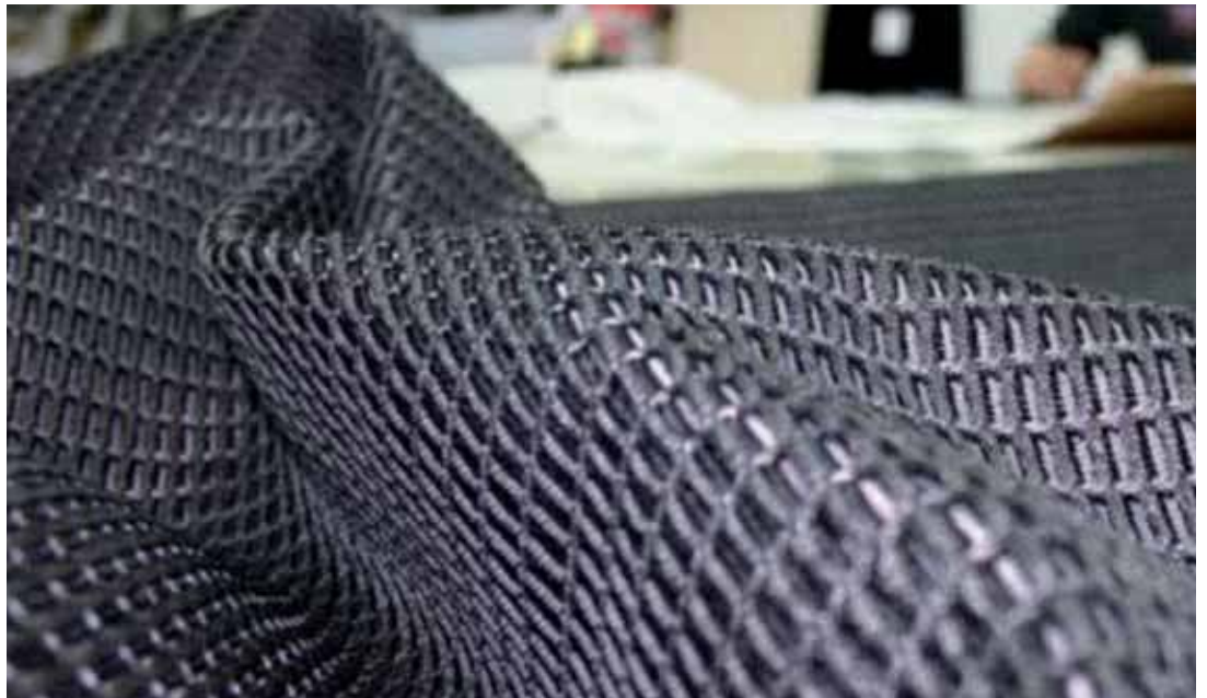
Particolare del Tessuto Attuabile Elettricamente. Sviluppato da Grado Zero Espace per ESA (ESA, 2005) A detail of the electrically controllable textile developed by Grado Zero Espace for ESA (ESA, 2005)
