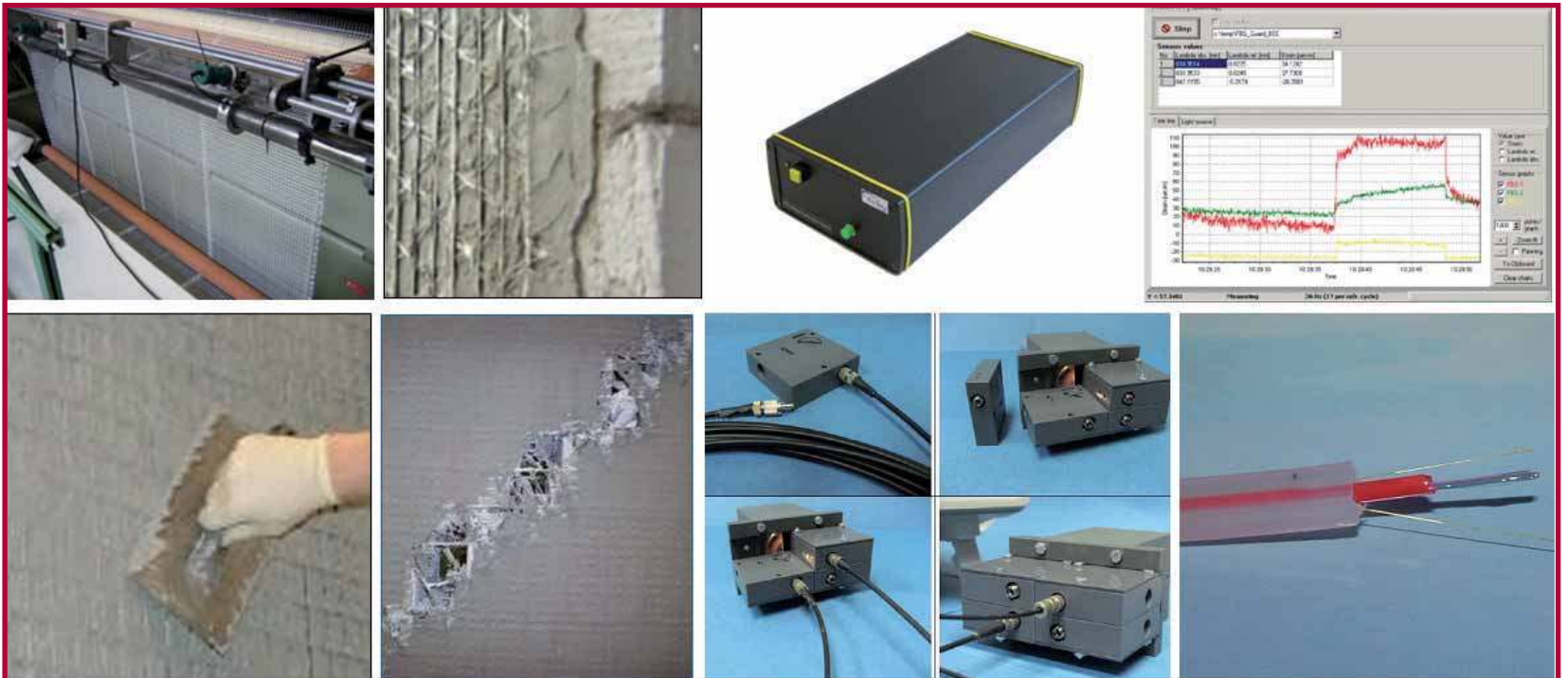
Figura 2. Alcuni risultati del progetto POLYTECT: applicazione e test della tappezzeria antisismica in composito (Karlsruhe Institute of Technology, KIT, Germania) con un rinforzo tessile sensorizzato (STFI, Germania, e SELCOM, Italia), e sensori a fibra ottica e centraline di acquisizione (Smartec, Svizzera, e Interlab, Spagna) Figure 2. Several Polyteect Products: the application and testing of the seismic wallpaper composite (Karlsruhe Institute of Technology, KIT, Germany), with a sensor embedded textile pattern (STFI, Germany, and SELCOM, Italy), and novel fiber optic sensors and equipment (Smartec, Switzerland, and Interlab, Spain)
