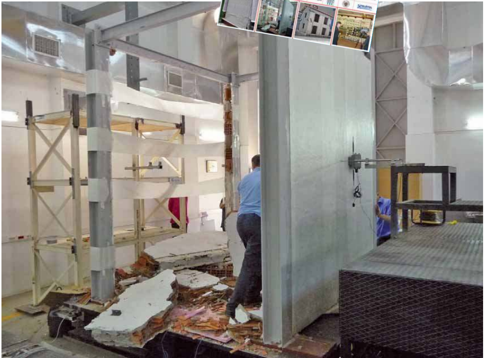
Figura 6. Test sismico su tavola vibrante condotto presso l'Università Bogazici di Istanbul (a sinistra il muro non rinforzato, crollato, e a destra quello rinforzato con la tappezzeria composite antisismica) (KIT, Germania) Figure 6. Shaking table test at Bogazici University Istanbul (on the left side the non-strengthened wall, on the right side the wall strengthened with the seismic wallpaper composite) (credits: KIT, Germany)
